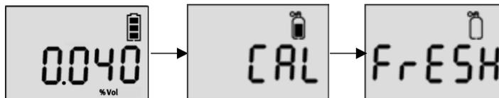
1. En la pantalla de medición, presione y mantenga presionado el botón pulsador y el botón de encendido para ingresar al modo de ajuste.
